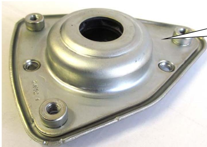
Alle Teile vom Domlager entfernen. Domlager gründlich reinigen.
